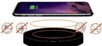
(PL) W celu zapewnienia optymalnego i bezpiecznego ładowania urządzenia, należy unikać wszelkich elementów metalowych pomiędzy urządzeniem a bazą ładowającą.
