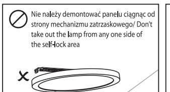
Nie należy demontażu panelu ciągnąc od strony mechanizmu zatraskowego/Don't take out the lamp from any one side of the self-lock area
