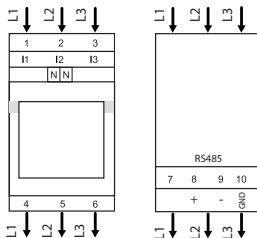
推荐的RS-485电缆：2x0.5mm<sup>2</sup>屏蔽双绞线。
