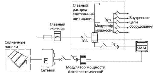
**Внимание!** Убедитесь, что модулятор мощности (0695000-400) измеряет всю электрическую мощность, потребляемую домом, в том числе необходимую для зарядки электромобиля. Модулятор мощности фотоэлектрической системы должен измерять только электрическую мощность фотоэлектрической системы.
