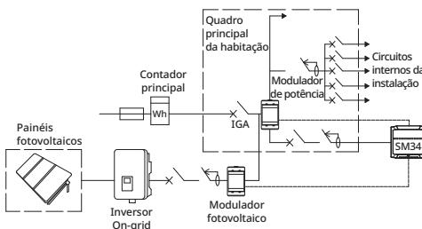
**Atenção!** Verifique se o modulador de potência (0695000-400) mede todo o consumo da habitação, incluindo o consumo do veículo elétrico. O modulador fotovoltaico deve medir apenas a produção fotovoltaica.
