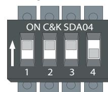
Antes de realizar la configuración desde la APP, asegurarse que la configuración del switch del cargador es la correcta:
