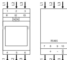
Zalecany kabel RS-485: skrętka ekranowana 2 × 0,5 mm<sup>2</sup>. Podłącz kabel komunikacyjny RS485 do elektroniki SM34, jak pokazano:
