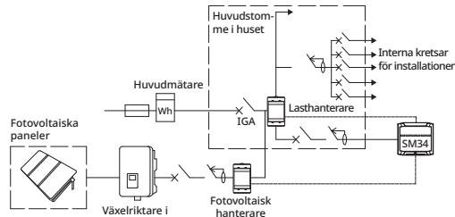
**Varning!** Säkerställ att lasthanteraren (0695000-400) mäter all förbrukning i hushållet, inklusive elfordonets förbrukning. Den fotovoltaiska hanteraren bör endast mäta den fotovoltaiska produktionen.
