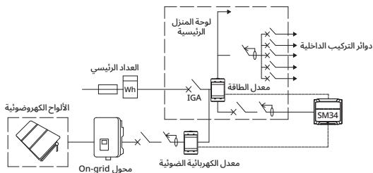
**انتبه!** تحقق من أن معدل الطاقة (0695000-400) يقيس استهلاك المنزل كاملاً، بما في ذلك استهلاك المركبة الكهربائية. يجب أن يقيس المعدل الكهروضوئي توليد الكهربائية الضوئية فقط.
