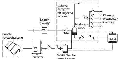
**Uwaga!** Sprawdź, czy modulator mocy (0695000-400) mierzy całe zużycie w domu, w tym zużycie pojazdu elektrycznego. Modulator fotowoltaiczny może mierzyć tylko generację fotowoltaiczną.
