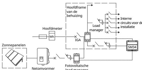
**Waarschuwing!** Controleer of de load manager (0695000-400) het volledige verbruik van het huishouden meet, inclusief het verbruik van het elektrische voertuig. De fotovoltaïsche load manager moet alleen het opgewekte fotovoltaïsche vermogen meten.
