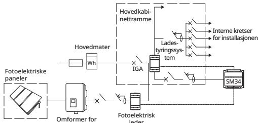
**Advarsel!** Kontroller at ladestyringssystemet (0695000-400) mäter alt husholdningsforbruk, inkludert forbruket til el-kjøretøy. Fotoelektrisk styringssystem skal kun måle fotoelektrisk generering.
