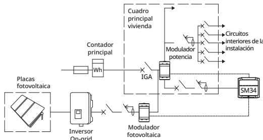
**Atención!** Verifique que el modulador de potencia (0695000-400) mida todos los consumos de la vivienda, incluido el consumo del vehículo eléctrico. El modulador de fotovoltaica debe medir únicamente la generación de fotovoltaica.
