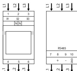
Câble RS-485 recommandé : paire torsadée et blindée de 2 x 0,5 mm<sup>2</sup>.
