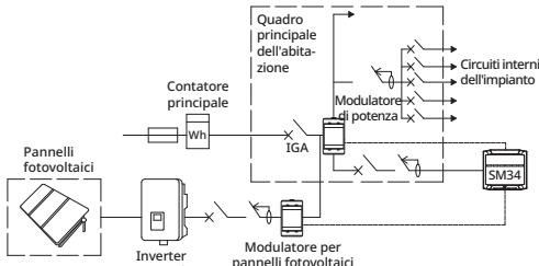
**Attenzione!** Verificare che il modulatore di potenza (0695000-400) misuri tutti i consumi dell'abitazione, compresi quelli del veicolo elettrico. Il modulatore per pannelli fotovoltaici deve misurare solo la generazione dei pannelli fotovoltaici.
