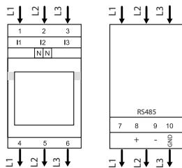
RS-485-kabel anbefales: skjermet og tvunnet par, 2 x 0,5 mm<sup>2</sup>.
