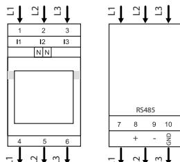
HRS-485 kabel rekommenderas: flätad och inkapslad slang i par, 2 x 0,5 mm<sup>2</sup>.
