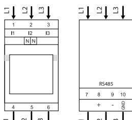
RS-485-kabel aanbevolen: afgeschermd en getwist paar, 2 x 0,5 mm<sup>2</sup>.
