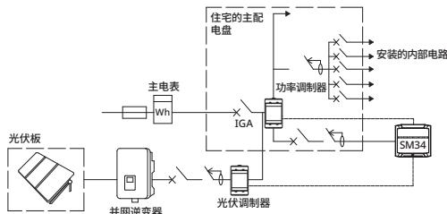
**注意！**检查功率调制器(0695000-400)是否测量了住宅内的所有电消耗，包括电动汽车的消耗。光伏调制器应只测量光伏发电。
