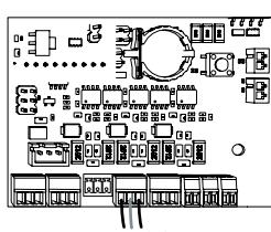
El modulador de fotovoltaica (0695000-060) siempre se debe combinar con el modulador de potencia de la vivienda (0695000-400) para su correcto funcionamiento.
