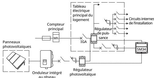
**Attention !** Vérifiez que le régulateur de puissance (0695000-400) mesure toute la consommation du logement y compris celle du véhicule électrique. Le régulateur photovoltaïque ne doit mesurer que l'électricité produite par les panneaux photovoltaïques.
