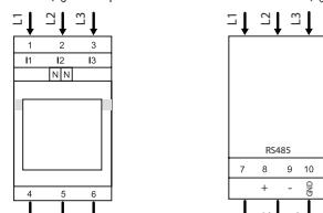
Рекомендуемый кабель RS-485: экранированная витая пара 2 x 0,5 мм<sup>2</sup>. Подключите кабель RS485 к электронному блоку SM34, как показано на рисунке:
