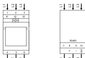
HRS-485 kabel rekommenderas: flätad och inkapslad slang i par, 2 x 0,5 mm<sup>2</sup>.
