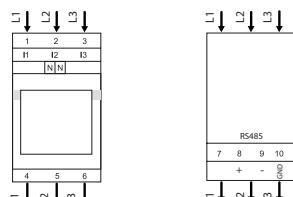
Zalecaný kabel RS-485: skrętka ekranowana 2 × 0,5 mm<sup>2</sup>. Podłącz kabel komunikacyjny RS485 do elektroniki SM34, jak pokazano:
