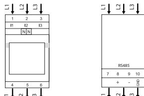
推荐的RS-485电缆：2x0,5mm<sup>2</sup>屏蔽双绞线。
