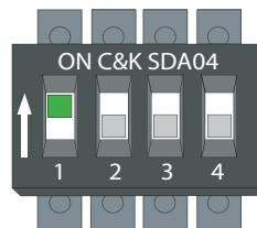
开关 1 → ON - 功率平衡启动
