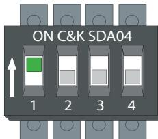
переключатель 1 → ВКЛ (ON) - Регулировка мощности включена;
