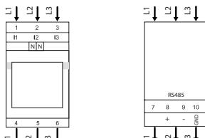
RS-485-kabel anbefales: skjermet og tvunnet par, 2 x 0,5 mm<sup>2</sup>.
