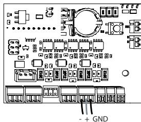
Для зарядных устройств с трехфазным модулятором для домашней системы электроснабжения: Между контактами 7 и 9 модулятора необходимо установить перемычку, которая будет служить окончанием шины RS-485.
