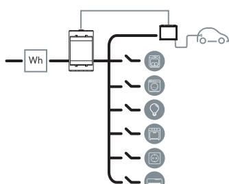
Connectez le régulateur comme indiqué sur le schéma suivant :
