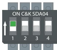
przełącznik 1 → ON - bilansowanie mocy włączone
