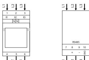
RS-485-kabel aanbevolen: afgeschermd en getwisted paar, 2 x 0,5 mm<sup>2</sup>.
