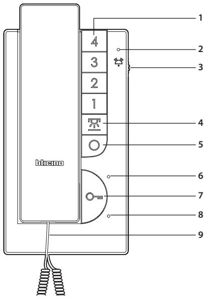
1. 4 tasti programmabili tramite configurazione
